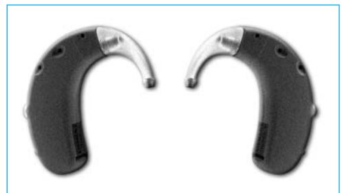
FIG. 10.8 AA digitale con ben visibile il pulsante per il cambio programma di riproduzione.
