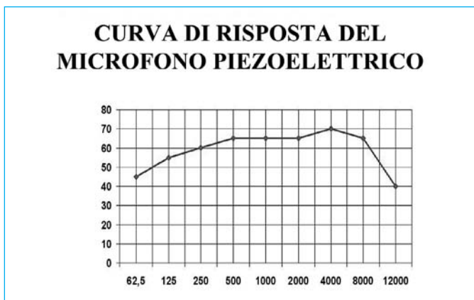
FIG. 9.6 Schematizzazione della curva di risposta di un microfono piezoelettrico.
