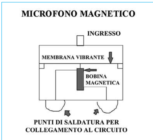
FIG. 9.3 Schematizzazione di un microfono magnetico
