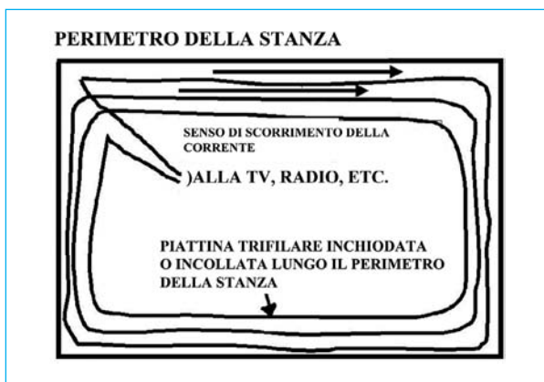
FIG. 9.14 Rappresentazione schematica di come si deve collegare una piattina trifilare per la creazione di un campo magnetico usufruibile mediante bobina telefonica in una normale stanza da appartamento.
