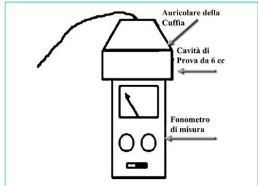
FIG. 4.1 Verifica della taratura di una cuffia mediante cavità di prova standard.
