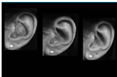
FIG. 10.2 Endoauricolari di foggia diversa.
