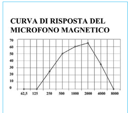
FIG. 9.4 Schematizzazione della curva di risposta di un microfono magnetico.
