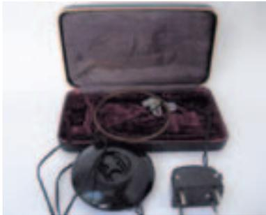
Si arriva così al 1938, anno in cui la Western Electric produsse l'apparecchio acustico "Ortho Tronic Audiphone" dove il regolatore del volume, di tipo meccanico fu applicato direttamente sul microfono a carbone. Era alimentato da una pila da 3 volt.
